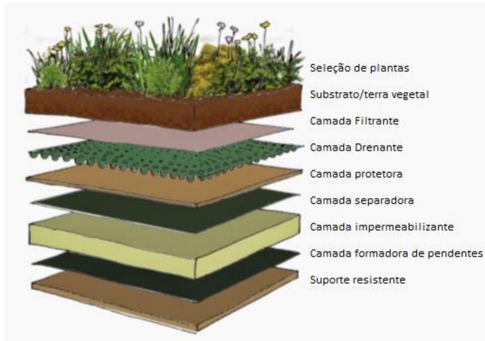
Figura 35 Camadas para implementação da cobertura verde. Fonte: (MOISES, 2017)
